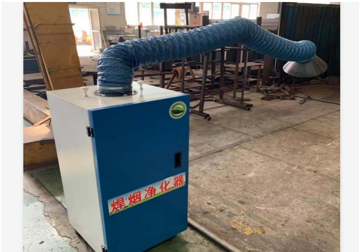
图 4-3 焊烟净化器现状图
